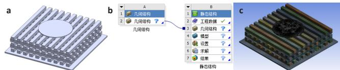
图注: a 为支架、压头与支撑板模型; b 为项目系统; c 为网格化结果
