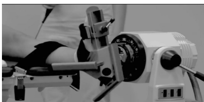
图注：该图片为踝关节的本体感觉测量，包括位置觉、力量觉以及运动觉图6 | 应用等速肌力测试仪进行踝关节位置觉、力量觉以及运动觉测试图
