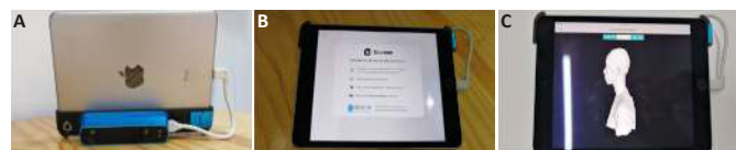
图注: 图 A 为三维光学扫描仪图片; B 为 Scanner APP 界面图; C 为颈部扫描图像
