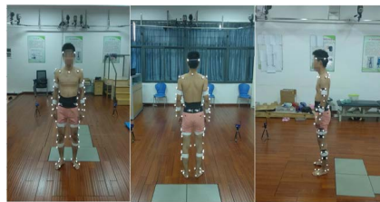
图注:按照CAST方案的要求放置54个荧光标记物
