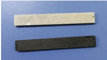
图 3 掺杂 1% 锌铁氧体磁性颗粒聚甲基丙烯酸甲酯骨水泥(黑色)与普通聚甲基丙烯酸甲酯骨水泥(白色)
