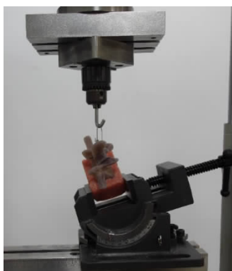
图 5 拔出试验装置图 Figure 5 Extraction test device
