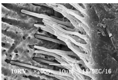
图2 ONE-STEP PLUS通用型光固化黏结剂黏结CAD/CAM一体化纤维桩核(扫描电镜)
