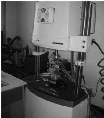
图2 美国 BOSE ESG 公司 ElectroForce3300 动态力学测试试验机
