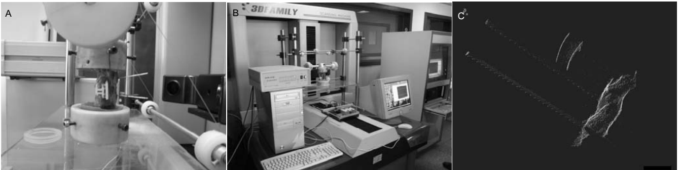
图4 羊腰椎的生物力学测试
