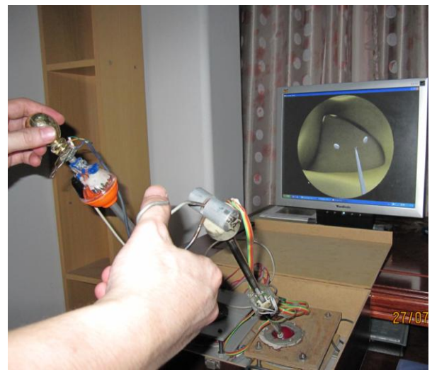
图4 受试者操作虚拟内镜系统双手训练游离体摘取的操作场景
