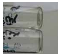
C: 在鲎试剂中加入 D, L-聚乳酸基形状记忆聚合物浸提液的样品管
