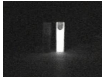
b: Colorimetric dishes image with the CCD light source distance of 50 cm 注: 光源距离比色皿距离增大后成像效果依然良好, 对荧光感应度高, 区分明显
