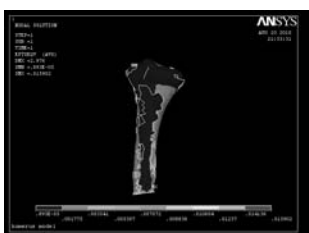
Figure 9 1 000 N axial load, the strain contour 图 9 施加 1 000 N 轴向载荷时的应变云图
