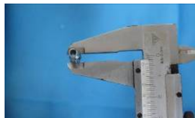
图 13 低温塑形后成形架横纵径
