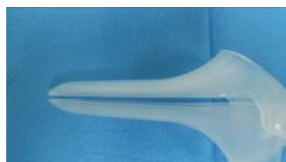
图 1 “鸭嘴形”成形架在低温时压扁合拢
