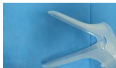
图 2 “鸭嘴形”成形架在升温后撑开
