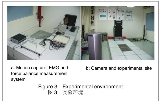
如图3a所示, 为Optotrak Certus (NDI, 加拿大)运动捕捉系统, 其最大采样频率为4 600 Hz, 最大标记点数量: 512个, 最小标记点直径4 mm。对所测量体段贴上光跟踪点或者先定义刚体然后通过刚体坐标计算虚拟光跟踪点, 采集运动数据并以3d Excel文件输出。测量运动的同时, 可以用AMT-8肌电仪(Bortec, 加拿大), 进行表面肌电信号(sEMG)的检测和处理, 测量信号由ODAU II (NDI, 加拿大)自动与运动信号同步, 即肌肉收缩时出现的电信号。如图3b所示, 为三维测力平衡系统(Bortec, 美国), 可以测量运动过程中脚底力大小。
